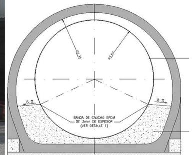
Tubería Forzada en Túnel de Aducción
