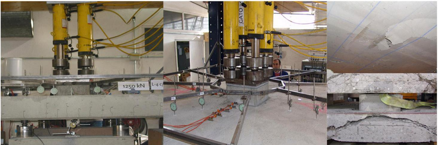
Estudio experimental de la resistencia a punzonamiento de losas planas con distintos detalles de armado, incluyendo soluciones muy habituales en la práctica en las cuales no existe conexión física entre la armadura de punzonamiento y la armadura traccionada o en las cuales la armadura de negativos no atraviesa el soporte sino que se corta y se refuerza lateralmente.
